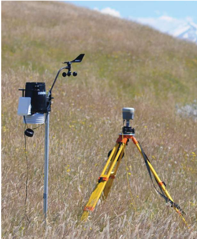
ALS Base Station
